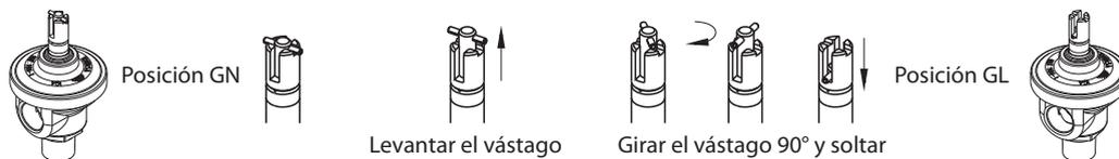
Si su modelo es termostático, roscar hasta que gire suelto el tornillo de regulación indicado (no tiene tope).
